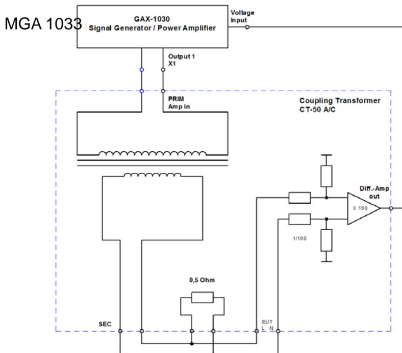
FIGURE CS101-3. Calibration
