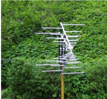
Antennen-Vorderteil der STLP 9128 D (kann von 200 MHz - 4 GHz auch ohne hintere Elemente benutzt werden)
