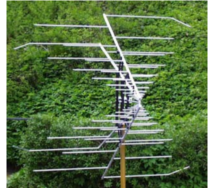
Komplett montierte Antenne STLP 9128D für 80-4000 MHz
