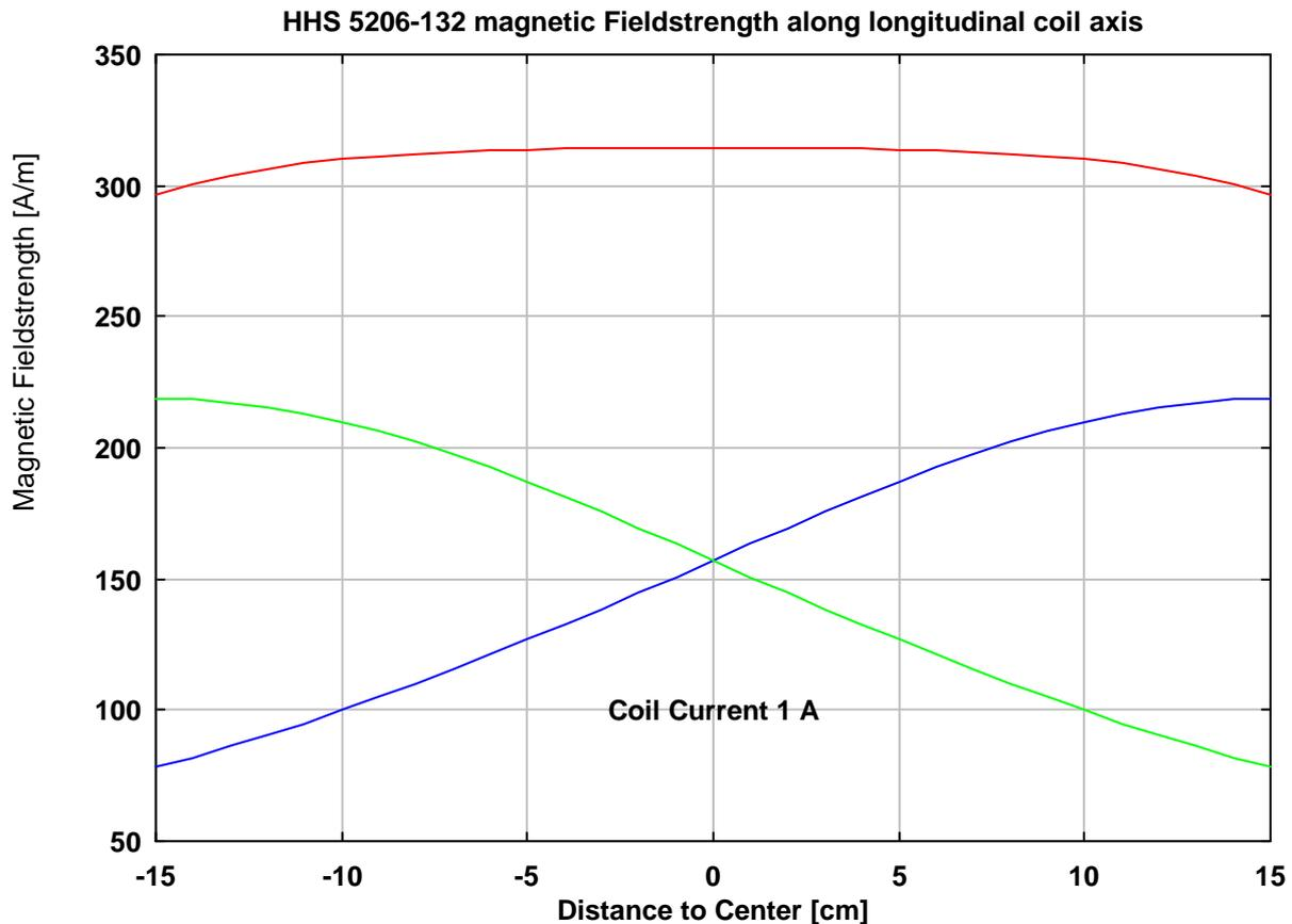
Längskomponente der magnetischen Feldstärke entlang der Spulenlängsachse
