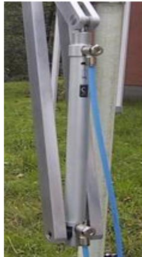
Einschrauben des Drosselventils reduziert die Drehgeschwindigkeit, herausdrehen des Ventils erhöht sie.
